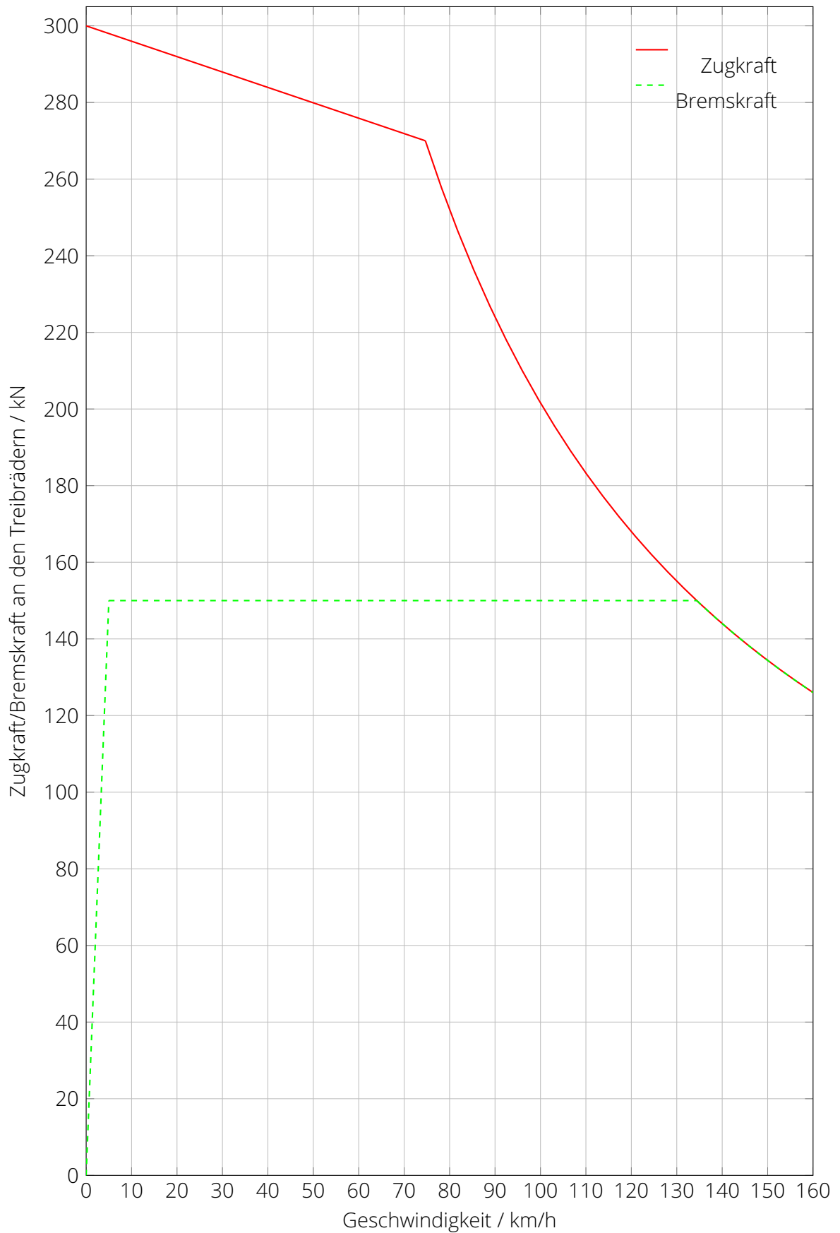
Abbildung 0.1: Zug- und Bremskraft-Diagramm der betrachteten Lokomotive
