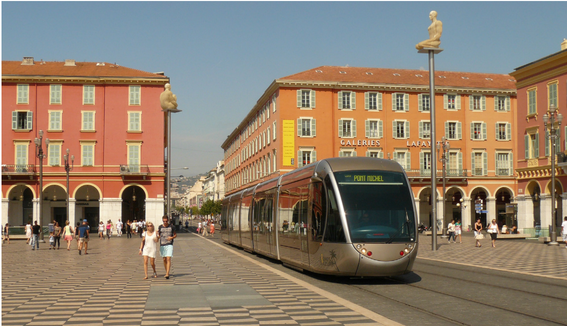
Abbildung 6.3: Straßenbahn in Nizza bei der Befahrung des Masséna Platzes im Stadtzentrum, der aus ästhetischen Gründen ohne Oberleitung geblieben ist.
