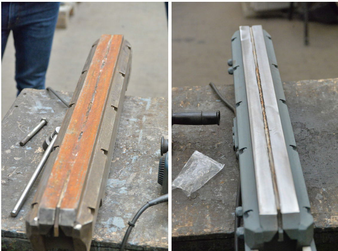
(a) Bremsmagnet mit Aufschieferungen vor der Aufarbeitung (b) Bremsmagnet nach der Aufarbeitung im Rahmen der Fahrzeuginstandhaltung
