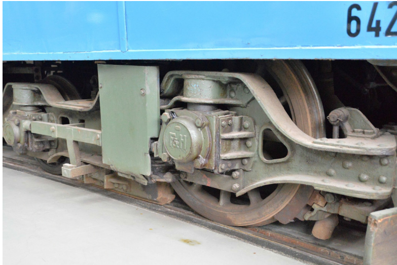
(a) Klotzbremse an einem Straßenbahnwagen des Typs F 2.10 (München)
