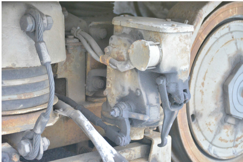
(b) Solenoidbremse (als Trommelbremse wirkend) an einem Tatra T4
