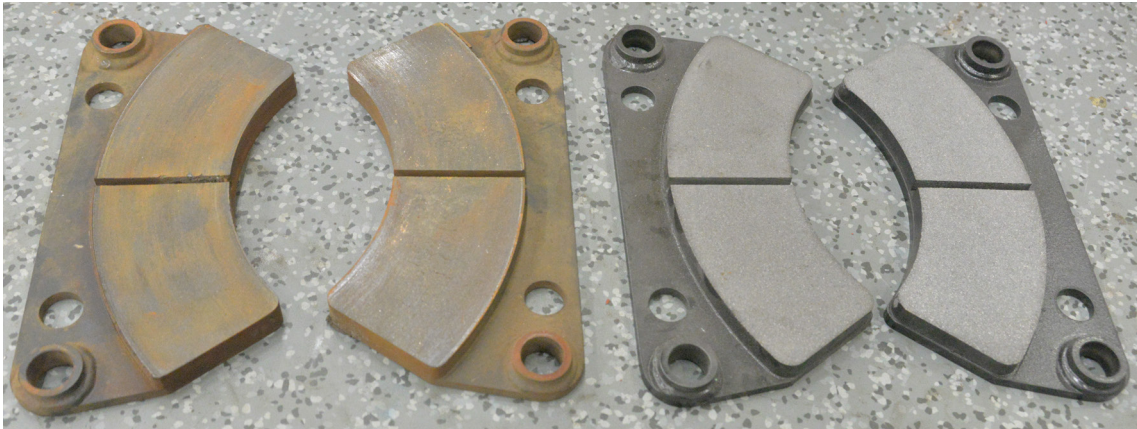
Abbildung 5.35: Gegenüberstellung von eingeschliffenen (links im Bild) und fabrikanneuen Bremsbelägen für eine Straßenbahn-Scheibenbremse
