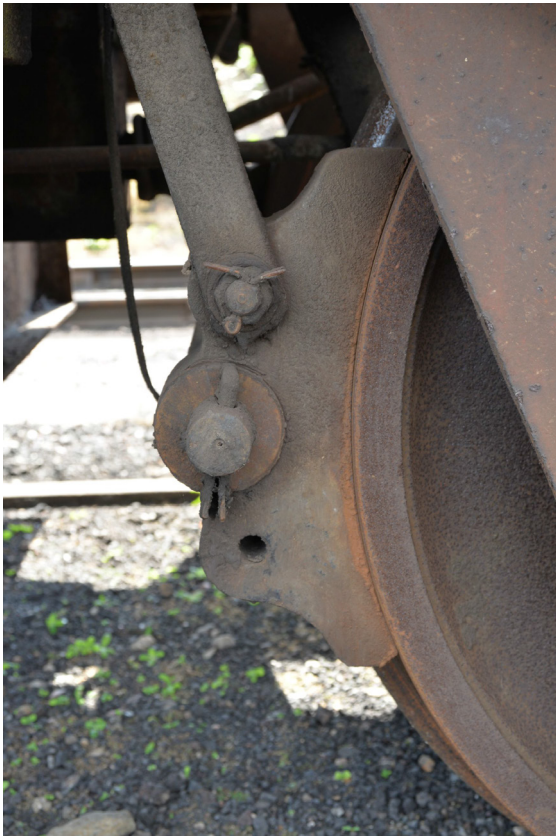
(a) Bauart B (ungeteilter Bremsklotz)
