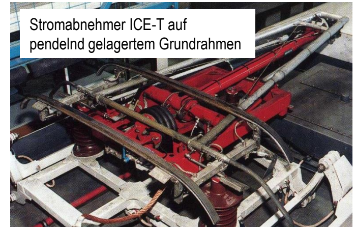
Abb. 7: Stromabnehmerjoch auf Drehgestellrahmen (Beispiel ICT)
