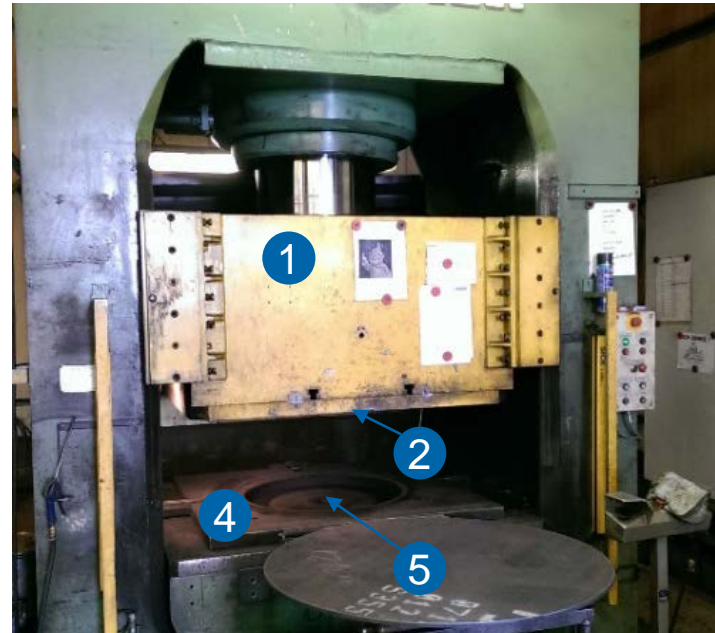
Tiefziehpresse ohne Niederhalter der Firma Blättner (1980) mit 800 kN Presskraft
