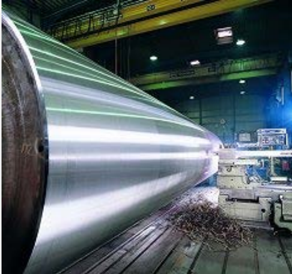
Spanende Bearbeitung einer Walze
