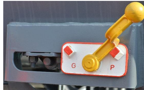
Bremsartwechsel an einem Güterwagen
