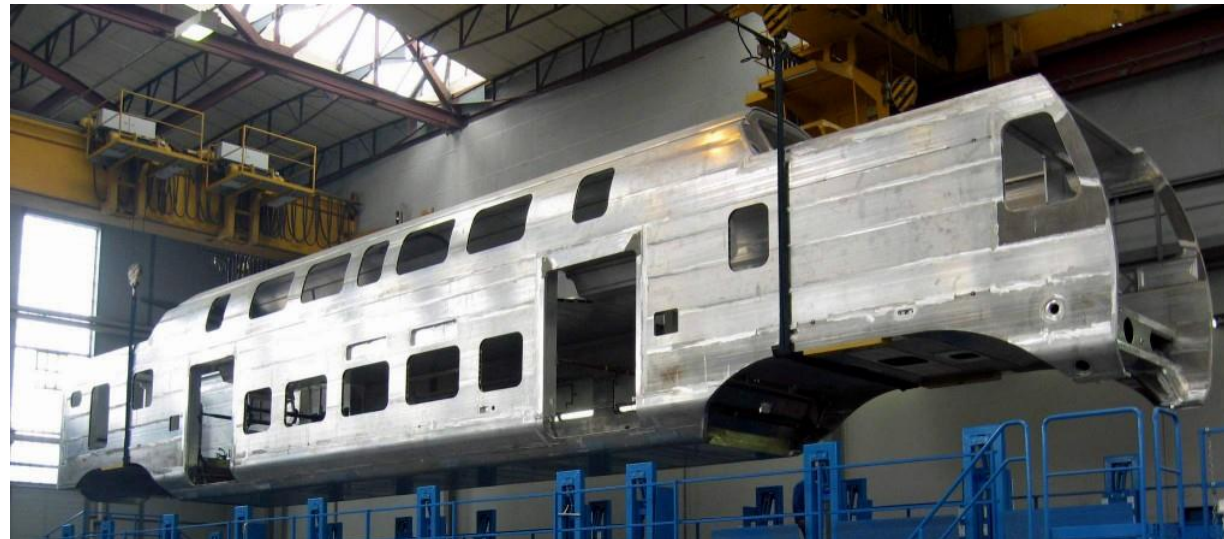
Wagenkasten Stadler KISS – Aluminium-Integralbauweise
