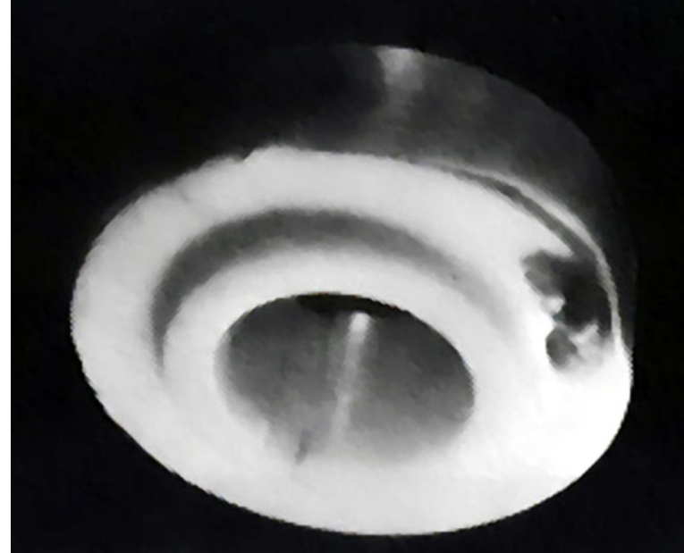
im Inneren aufgeschmolzene Rolle
