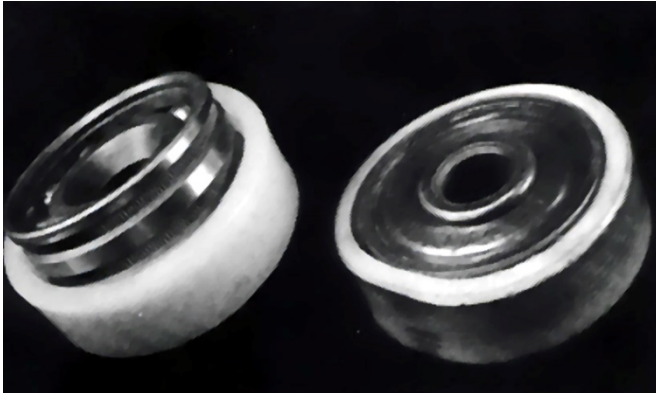
Durch Walkprozesse abgelöste zu dünnwandige Bandage
