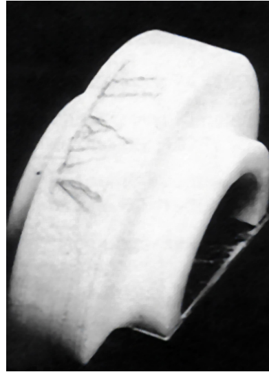
Dauerbrüche (Risse) auf den Oberflächen von Laufrollen aus PBT
