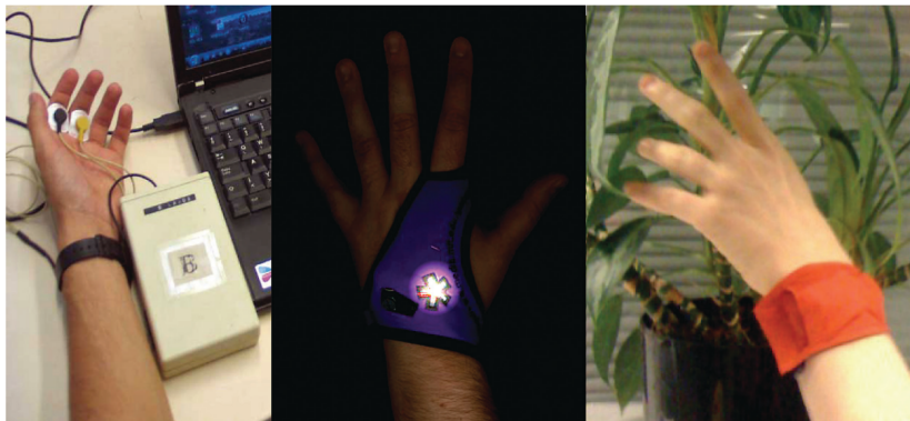
Abbildung 2: electrodermal activity sensors [5, S. 3]
