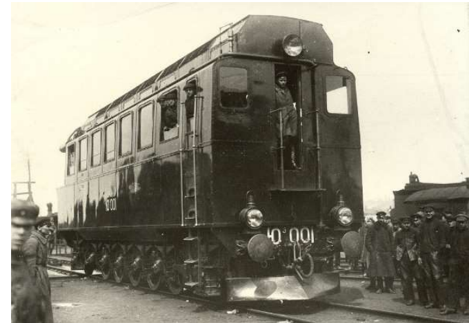
1923/24: Ee12 (Maschinenfabrik Esslingen) Gleichstrom-Gleichstrom – Übertragung, P_{DM} = 883 \text{ kW} , P_T = 800 \text{ kW}
