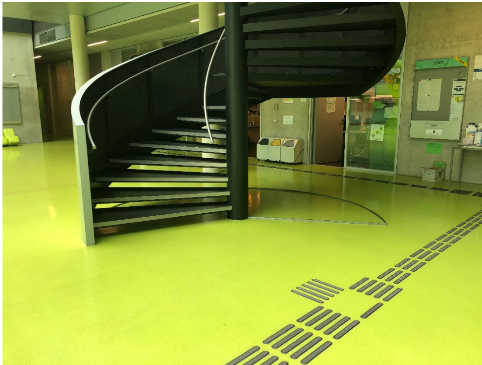
Unterlaufbare Treppen Orientierungs- und Leitsystem
