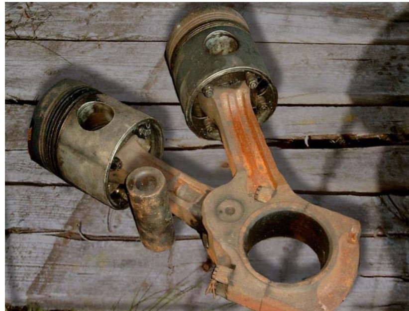
Anlenkpleuel des Dieselmotors Kolomna 5D49 V16
