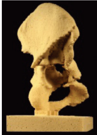
Gefrästes Modell eines Beckenausschnitts zur Anpassung einer Endoprothese
