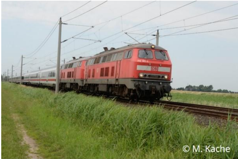
IC-Zug (10 Wagen) mit 2 x BR 218 im Flachland bei v = 120 \text{ km/h}
