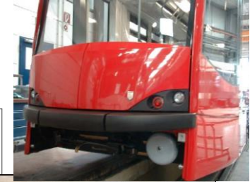
Crashabsorber aus Aluminiumschaum Schunk Sintermetalltechnik GmbH (Combindo® Bern)
