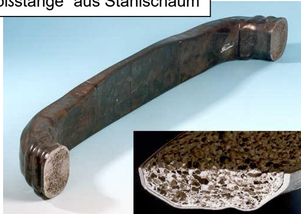
„Stoßstange“ aus Stahlschaum
