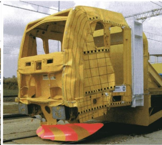
Bild 15: Deformationen am Versuchs-Frontsegment nach dem Crash-Versuch
