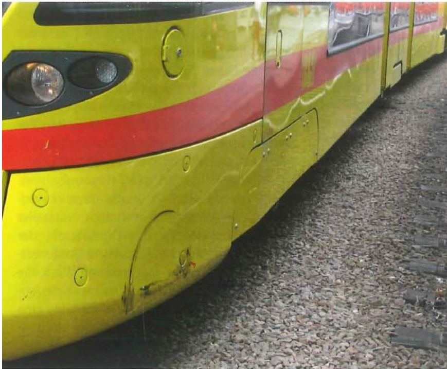
Abb. 9a und b: Seitliche Kollision mit Pkw mit einer Kollisionsgeschwindigkeit von ca. 40 km/h
