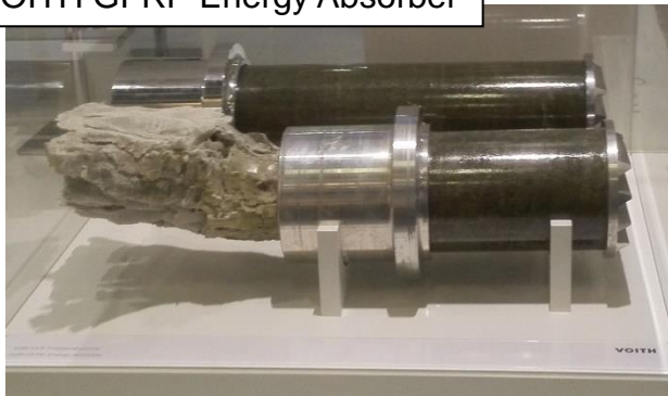
VOITH GFRP Energy Absorber
