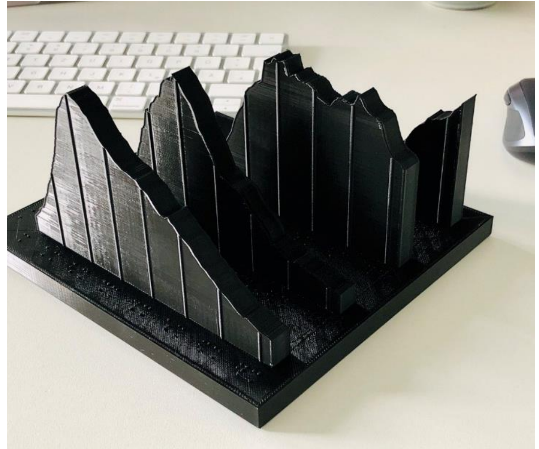
3D Modell eines Flächendiagramms hergestellt mit 3D-Drucker Quelle: Prof. MCI
