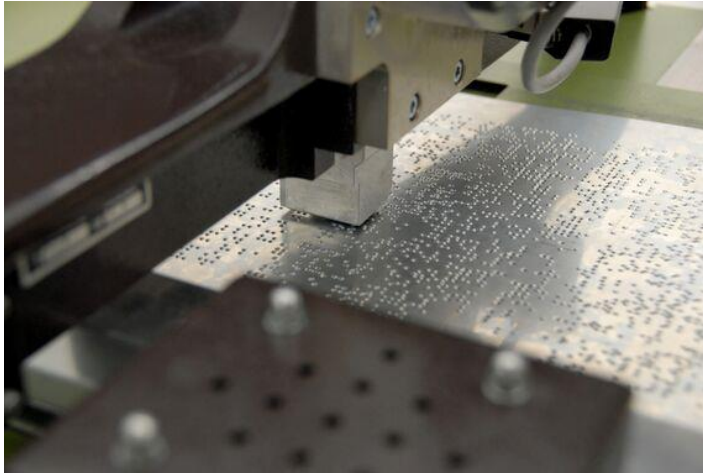
Prägen von Punkten in Zinkblech Quelle
