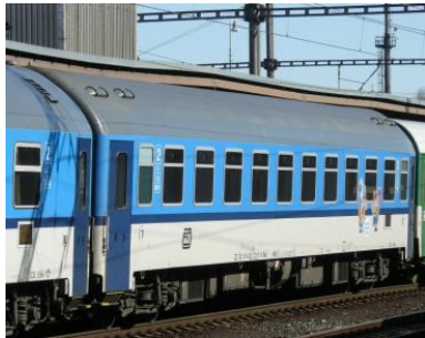
26,4m-Wagen: c_w = 0,11 (im Zugverband)
