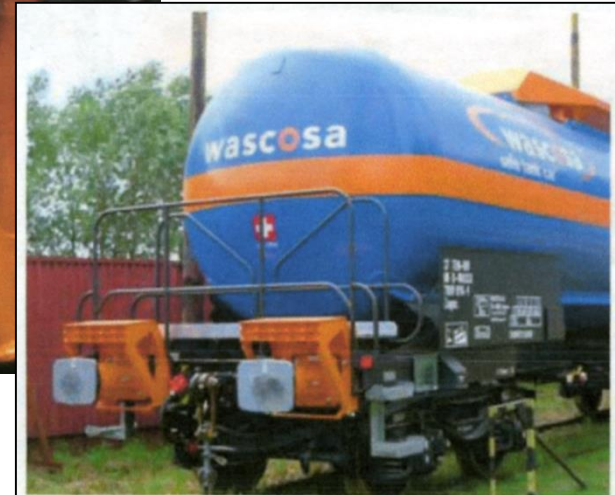
Sicherheits-Kesselwagen „Safe Tank Car“ von Wascosa. Die Komponenten des Sicherheitspakets werden in leuchtendem Orange hervorgehoben.
