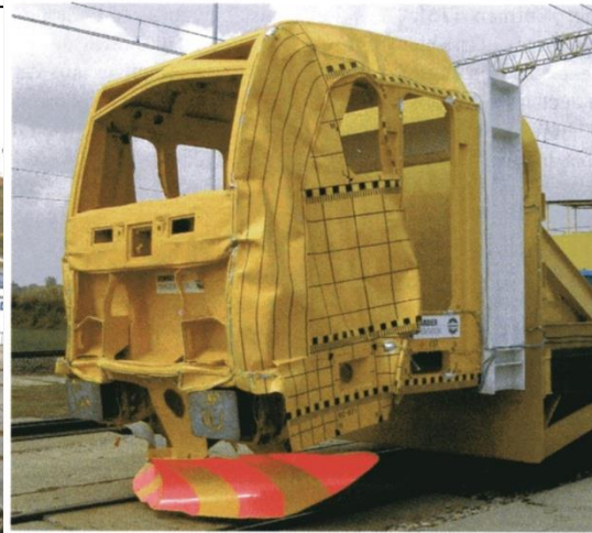
Bild 15: Deformationen am Versuchs-Frontsegment nach dem Crash-Versuch
