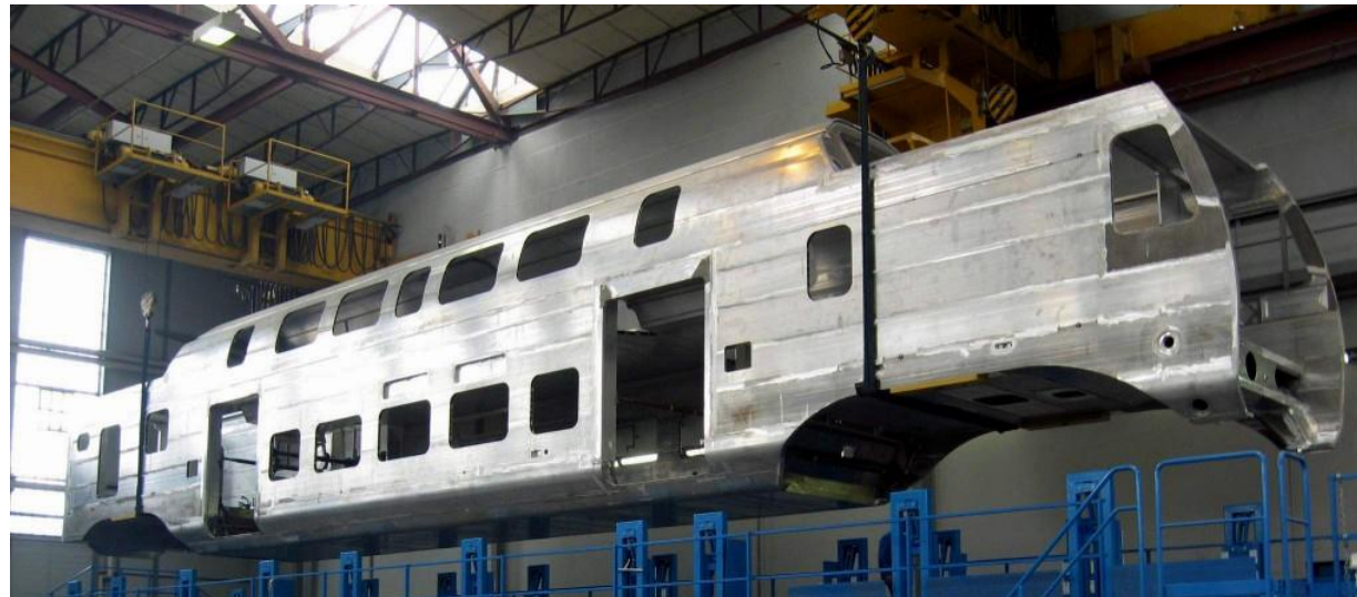
Wagenkasten Stadler KISS – Aluminium-Integralbauweise
